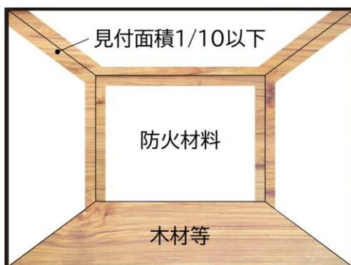
図 4-1 壁および天井の見付面積の 1/10 以下の部分
