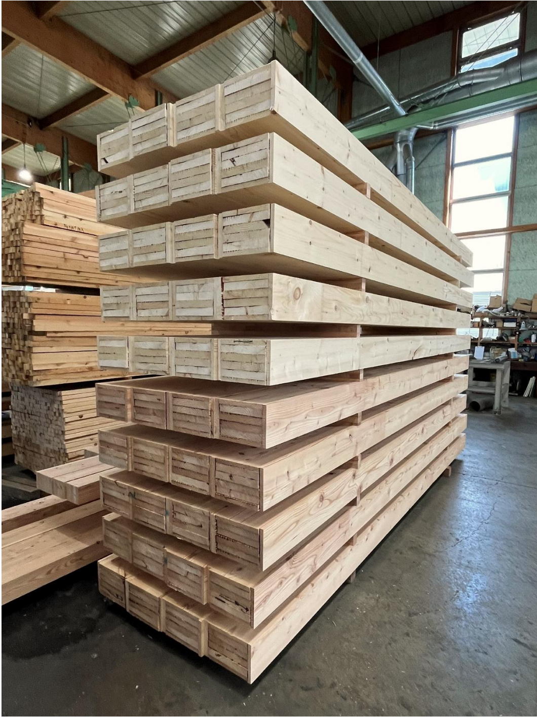
写真 1-4 切削・加工後の試験体（上：トドマツ、下：カラマツ）
