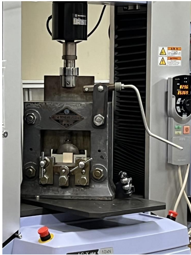
写真 1-7 ブロックせん断強度試験
