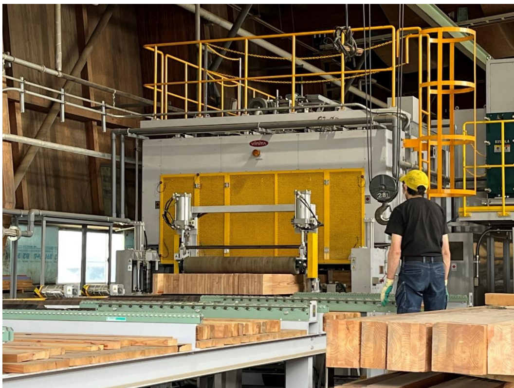
写真 2.1-11 高周波による積層接着（一次接着）
