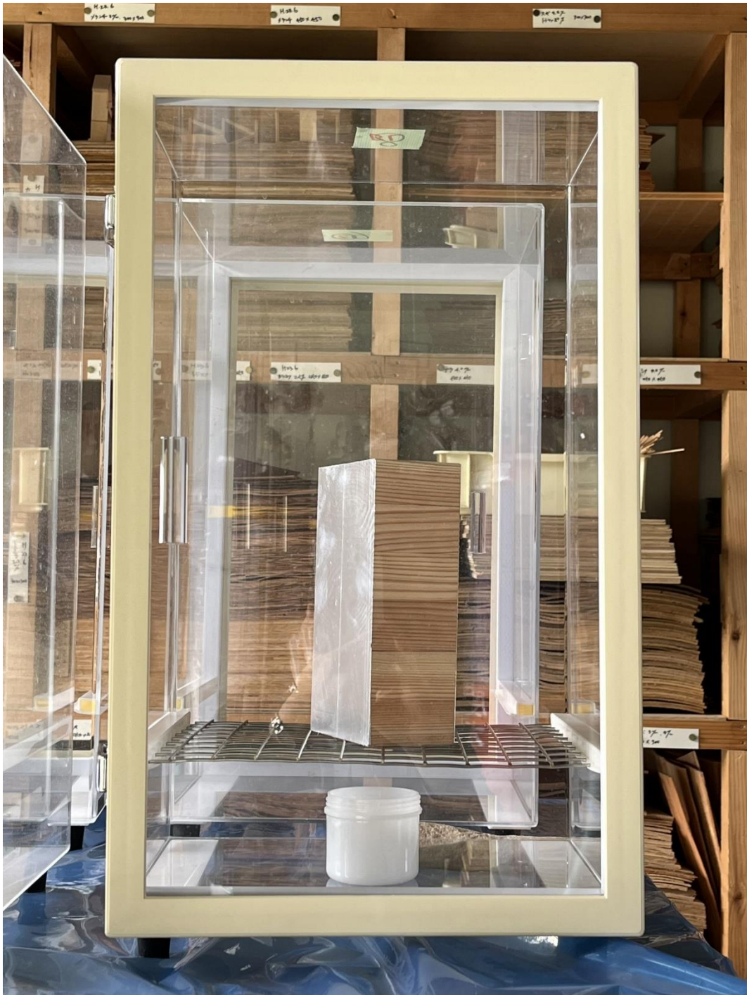
写真 1-6 ホルムアルデヒド放散量試験
