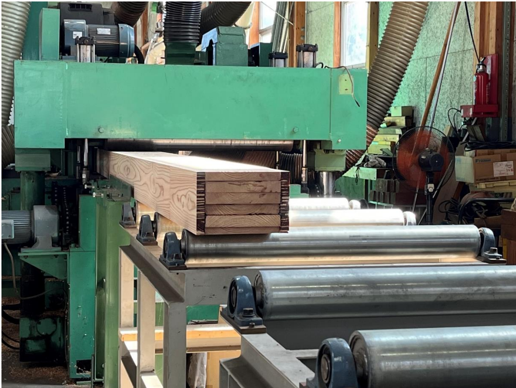
写真 2.1-18 四面プレナーによる性能・強度試験用試験体の加工
