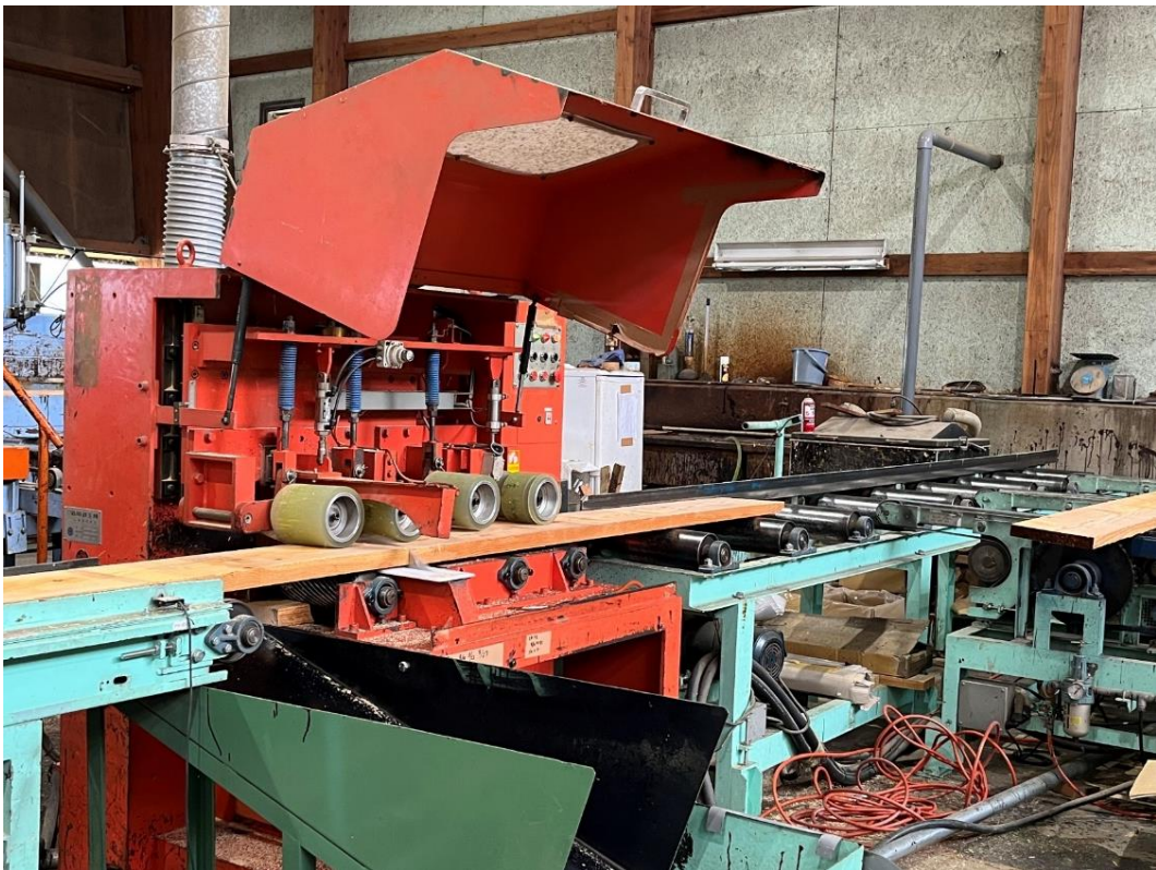
写真 2.1-6 クロスカットソーによる欠点等の除去
