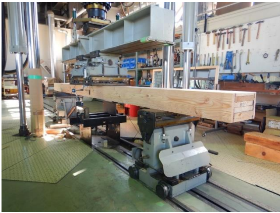
写真 3.1.3-1 曲げ試験の様子（カラマツ）
