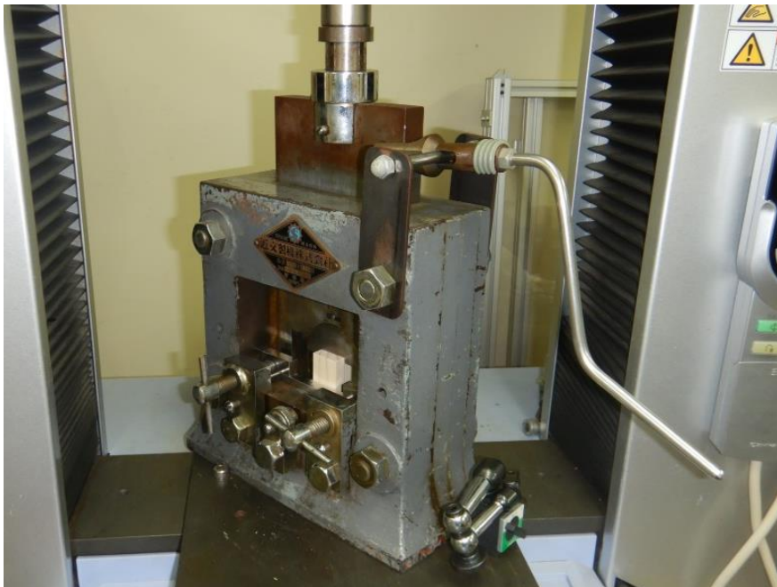
写真 3.1.4-1 ブロックせん断試験の様子
