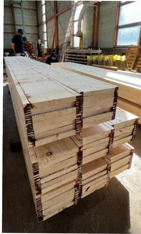
写真 2.1-17 寒冷地用集成ログ壁二次接着材（左：カラマツ、右：トドマツ）
