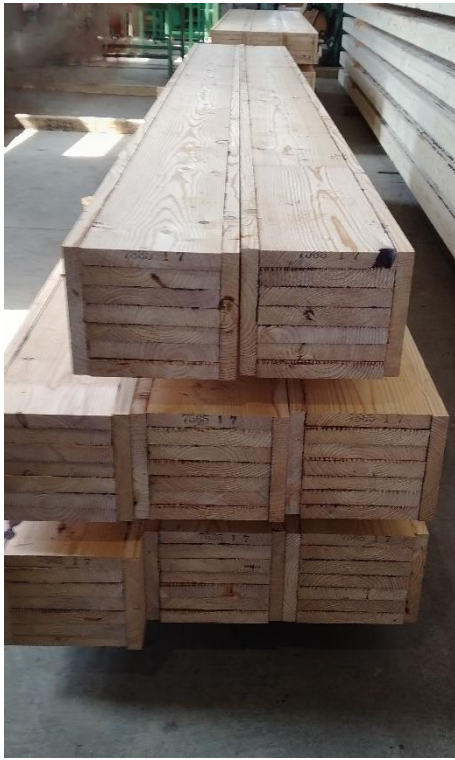
写真 2.1-17 寒冷地用集成ログ壁二次接着材（左：カラマツ、右：トドマツ）
