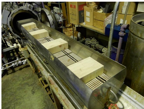
写真 3.1.1-2 減圧加圧処理の様子
