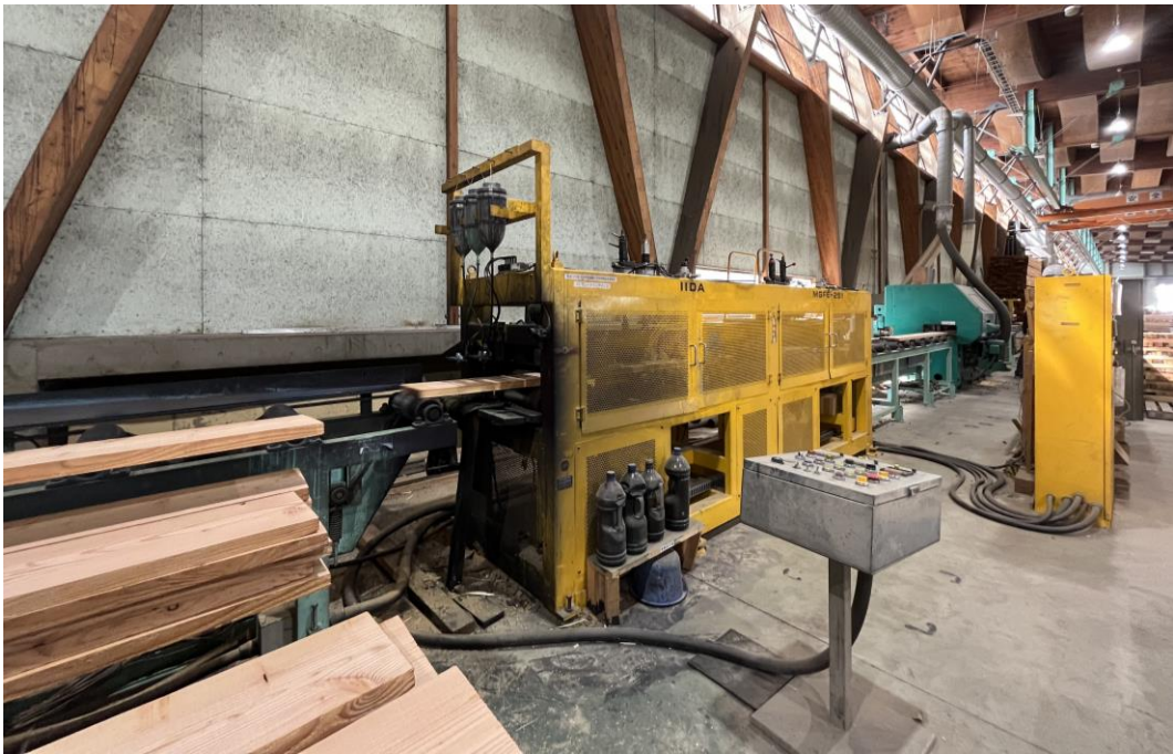
写真 2.1-5 グレーディングマシンによる強度検査
