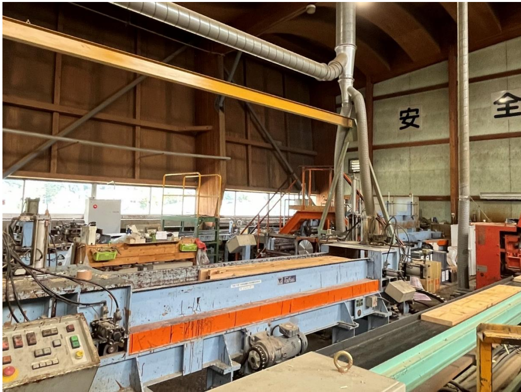
写真 2.1-7 フィンガープラントによるフィンガージョイント加工・接着
