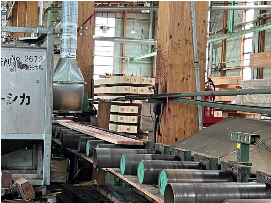
写真 2.1.13 平板材への接着剤塗布
