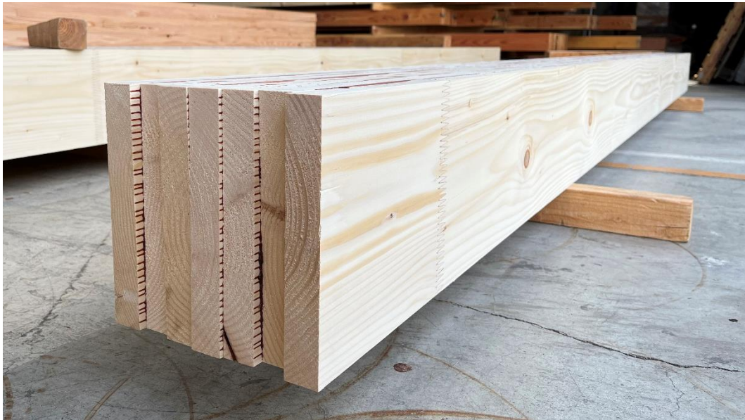
写真 1-2 規格化された大断面集成材（上：カラマツ、下：トドマツ）
