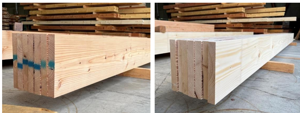
写真 2.1-12 一次接着後の大断面集成材（左：カラマツ、右：トドマツ）
