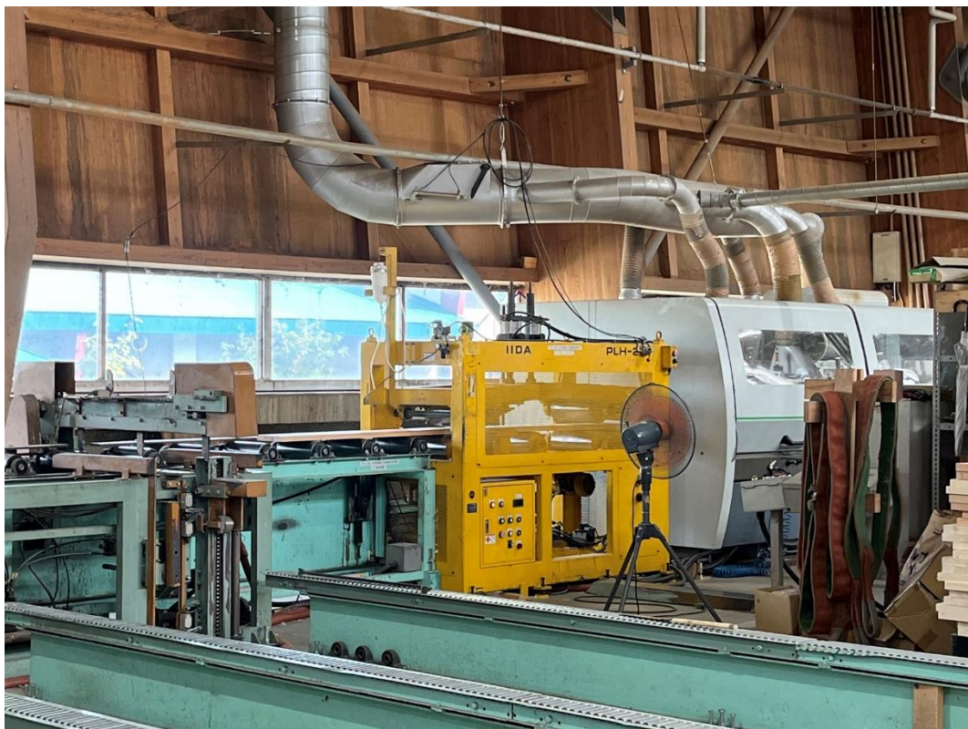
写真 2.1-8 仕上げモルダ（右）とブルーローダー（左）
