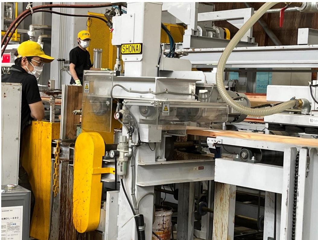
写真 2.1-10 シャワーコーターによるレジンノール塗布
