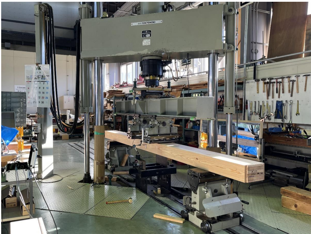
写真 1-8 曲げ強度試験
