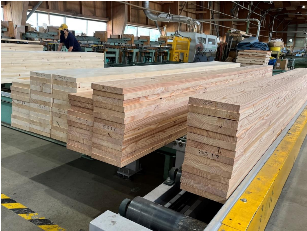
写真 2.1-9 フィンガージョイント接着・仕上げモルダー加工後のラミナ
