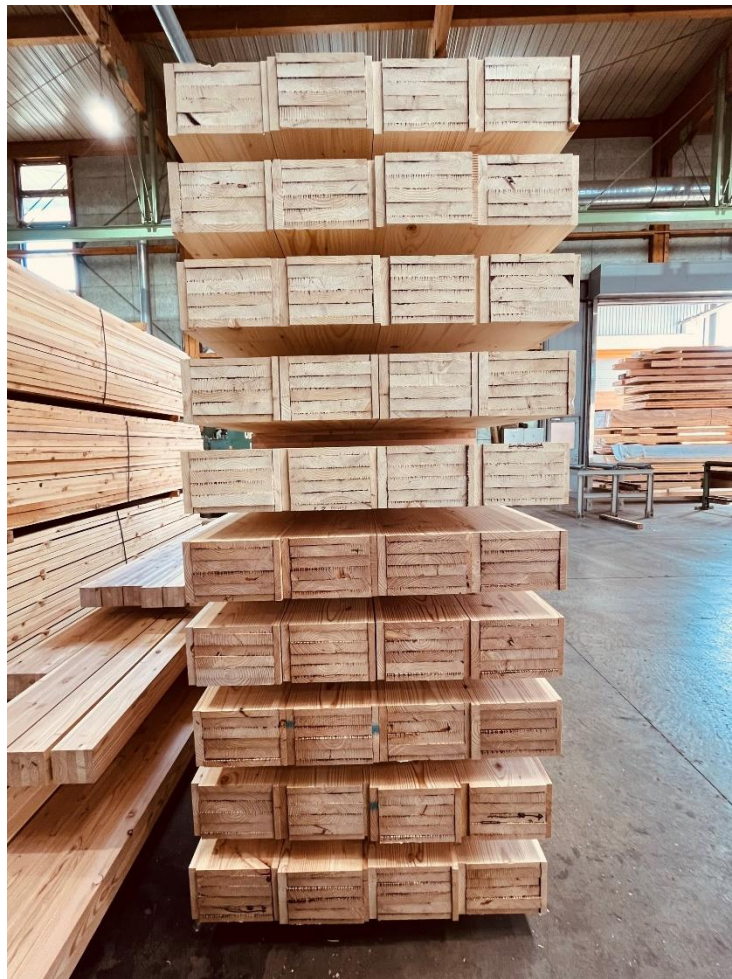
写真 2.1-19 性能・強度試験用試験体（上段：トドマツ、下段：カラマツ）
