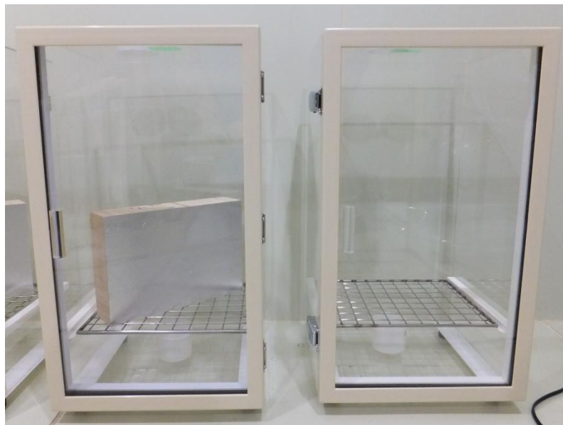
写真 3.1.2-1 左：試験片の測定、右：バックグラウンド測定
