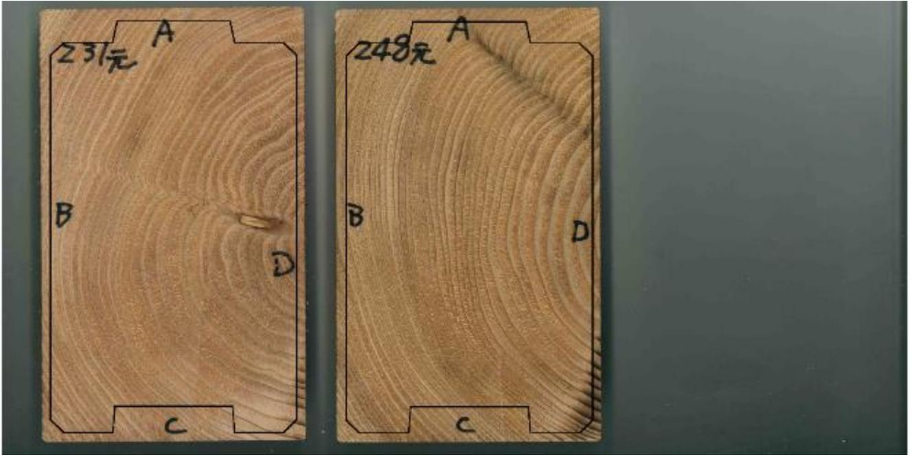
写真 3.2.5-7 乾燥スケジュール①の切片画像（その 7）と重ね合わせた角ログ断面図
