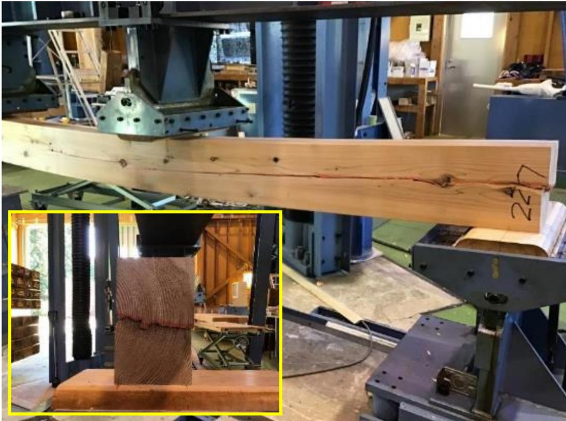
写真 3.2.6-1 セン断破壊した試験体
