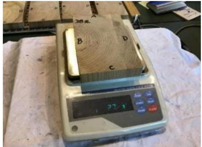
写真 1-13 全乾法による含水率測定 (恒温器を用いて試験体を全乾にし (左)、重量を測定 (右))
