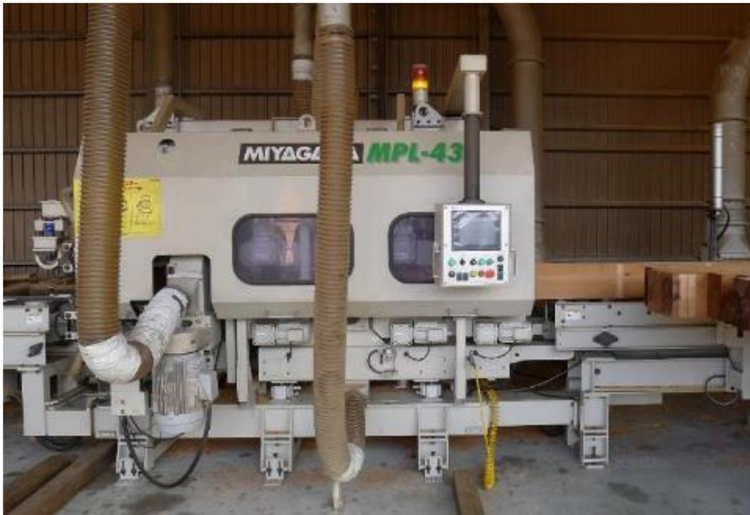
写真 1-8 仕上げ加工に用いた全自動四面鉋盤（MPL-43、宮川工機（株）製）
