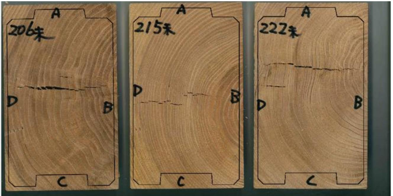
写真 3.2.5-41 乾燥スケジュール③の切片画像（その 13）と重ね合わせた角ログ断面図
