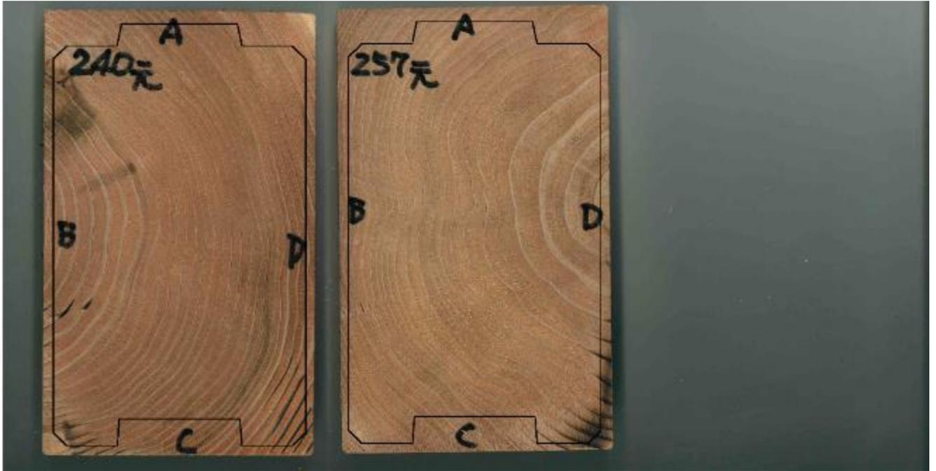
写真 3.2.5-21 乾燥スケジュール②の切片画像（その 7）と重ね合わせた角ログ断面図
