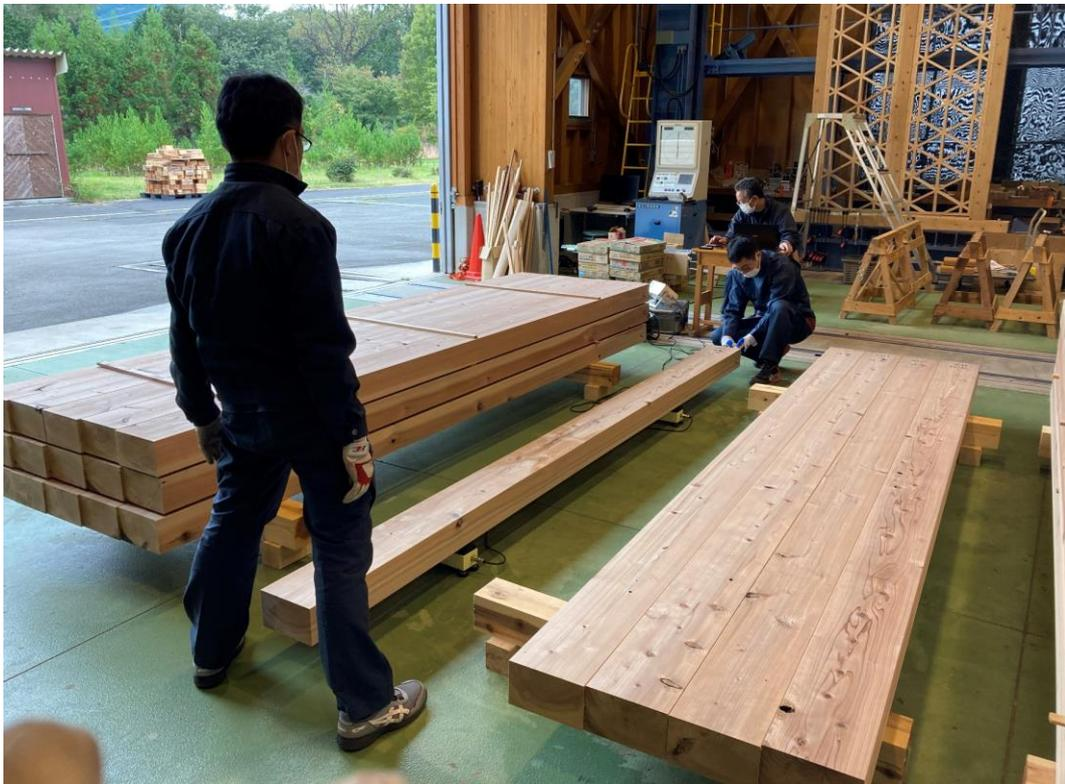
写真 3.1.6-1 縦振動法による測定の様子
