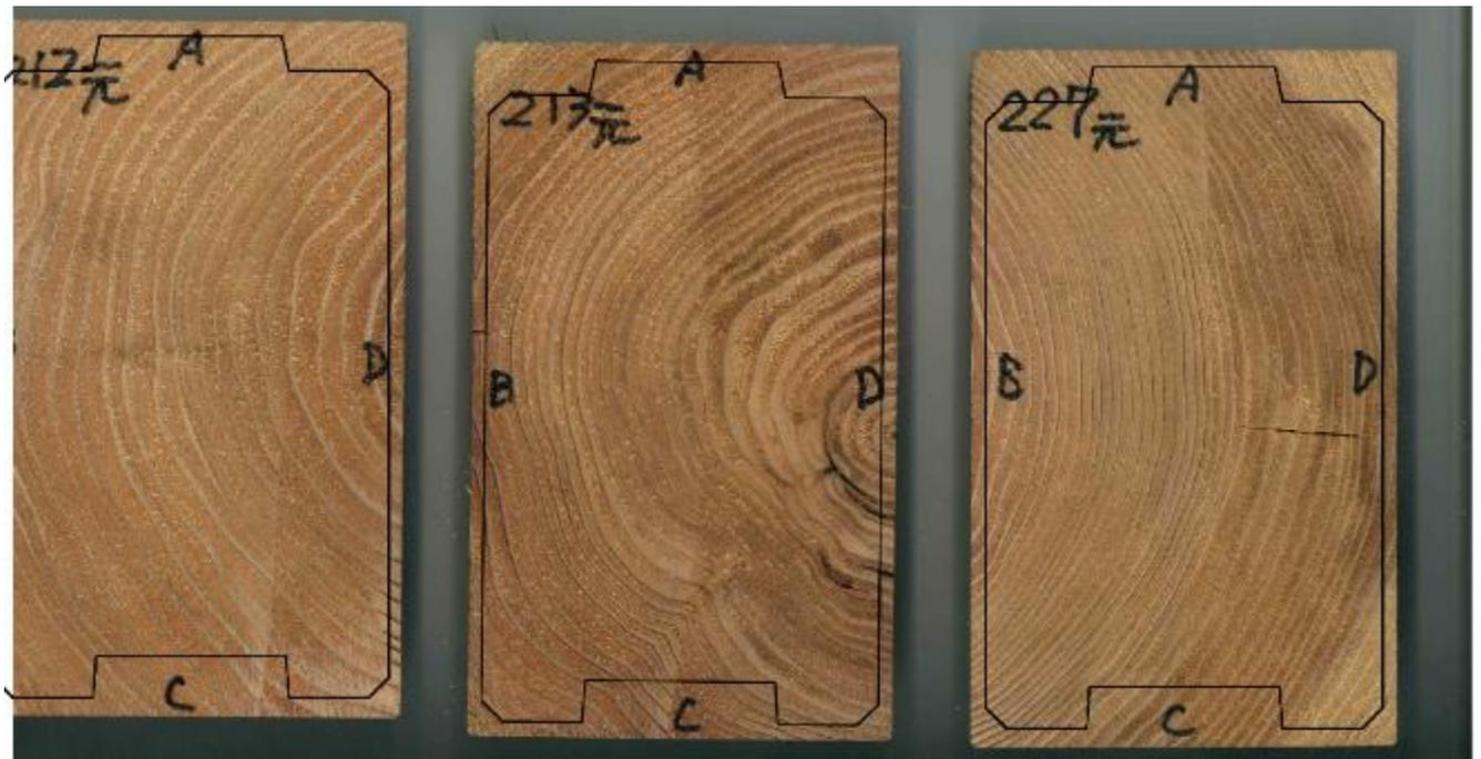
写真 3.2.5-6 乾燥スケジュール①の切片画像（その 6）と重ね合わせた角ログ断面図
