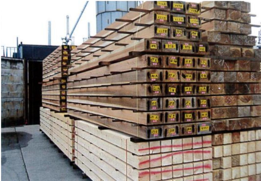
写真 1-4 乾燥試験（乾燥前の積み込み）
