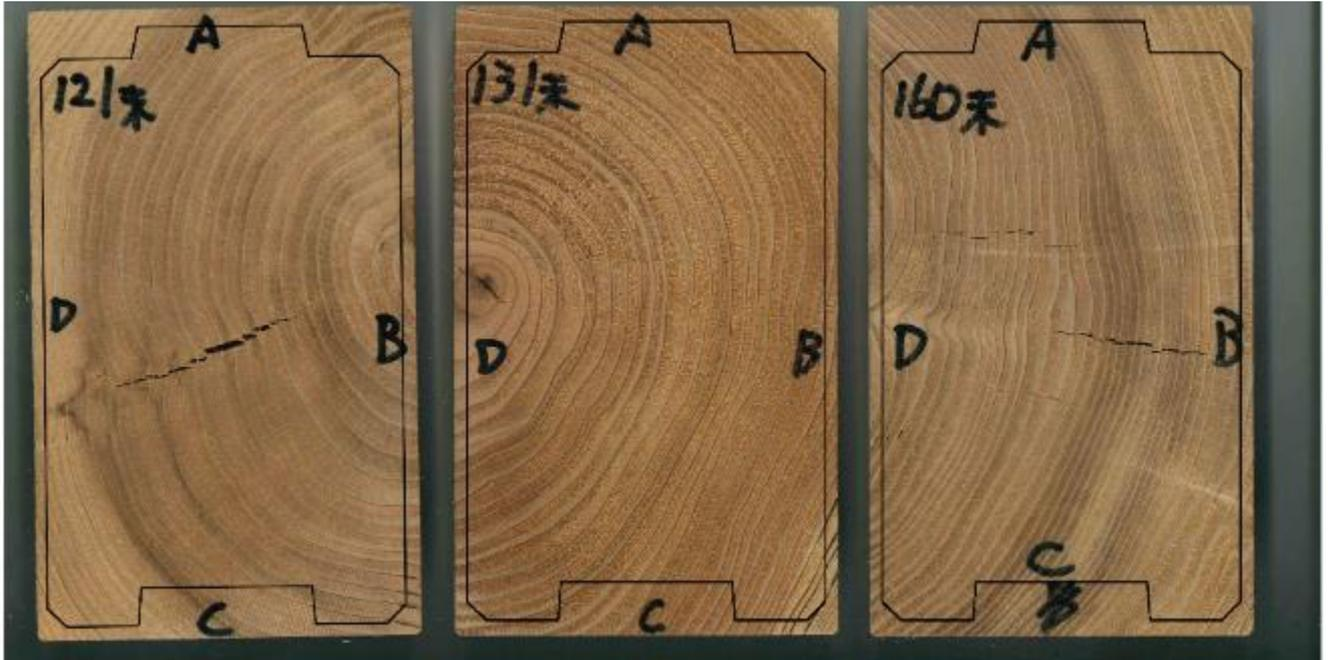
写真 3.2.5-39 乾燥スケジュール③の切片画像（その 11）と重ね合わせた角ログ断面図
