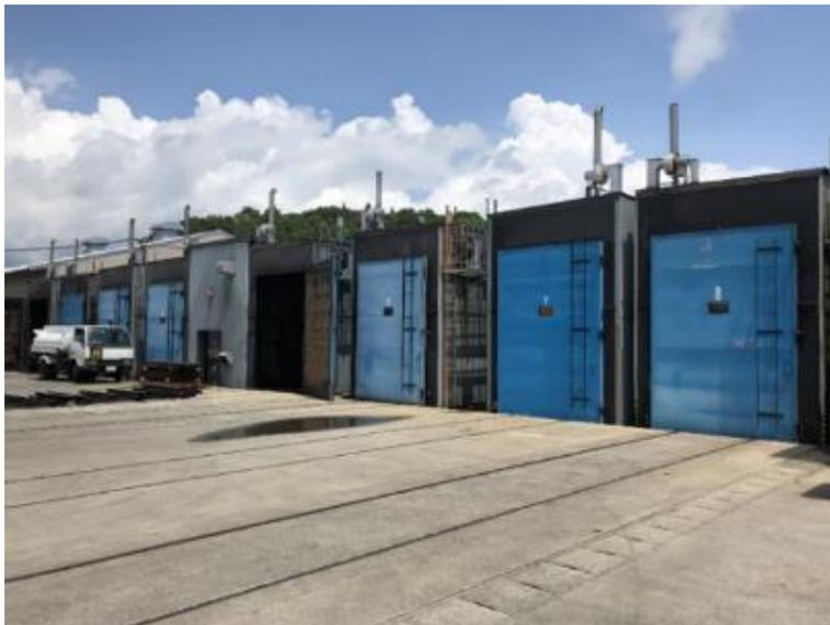
写真 2.3.1-1 高温セット処理に使用した高温タイプの蒸気式乾燥機
