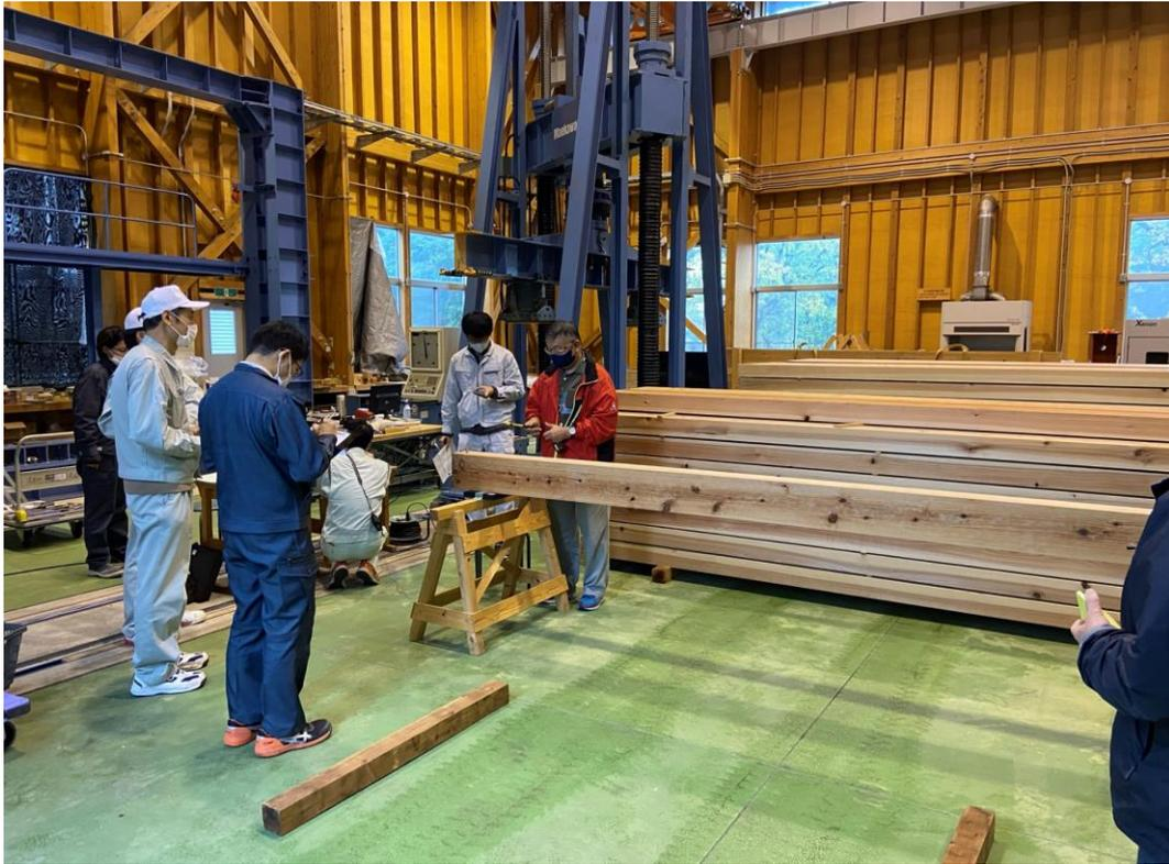
写真 3.1.6-2 TGH 法による測定の様子
