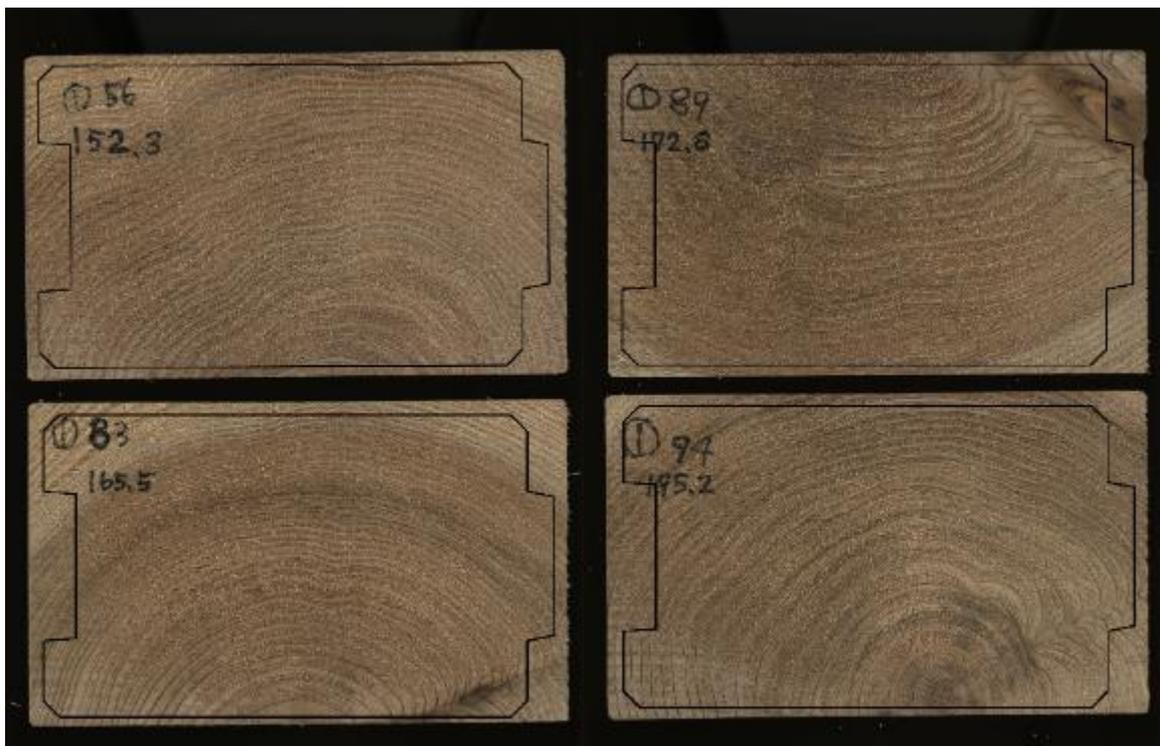
写真 3.2.5-44 乾燥スケジュール①の切片画像（ログ加工時その2）と重ね合わせた角ログ断面図
