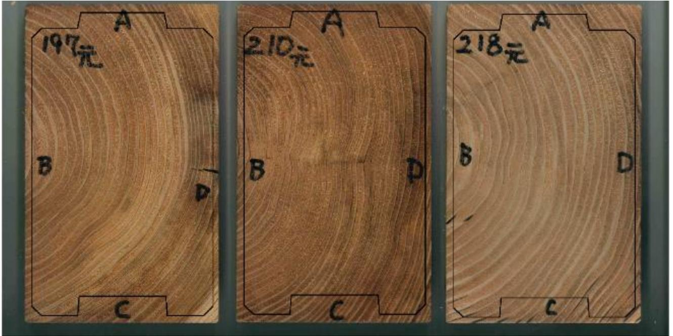
写真 3.2.5-19 乾燥スケジュール②の切片画像（その 5）と重ね合わせた角ログ断面図
