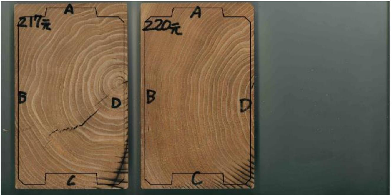
写真 3.2.5-35 乾燥スケジュール③の切片画像（その 7）と重ね合わせた角ログ断面図
