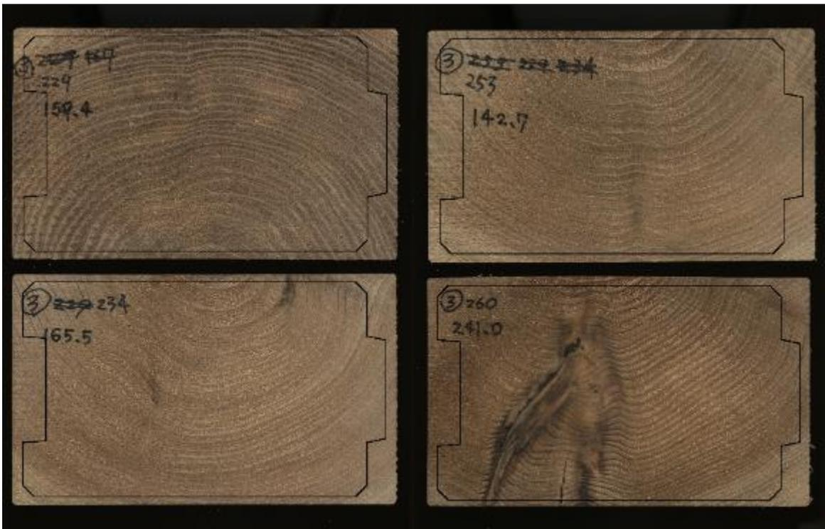
写真 3.2.5-52 乾燥スケジュール③の切片画像（ログ加工時その 3）と重ね合わせた角ログ断面図
