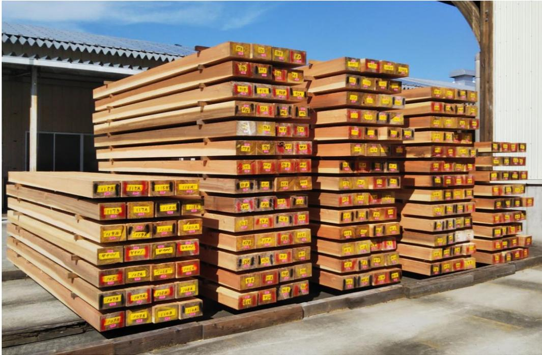
写真 1-3 選別前の試験体（乾燥条件ごとにスプレーで色付け）
