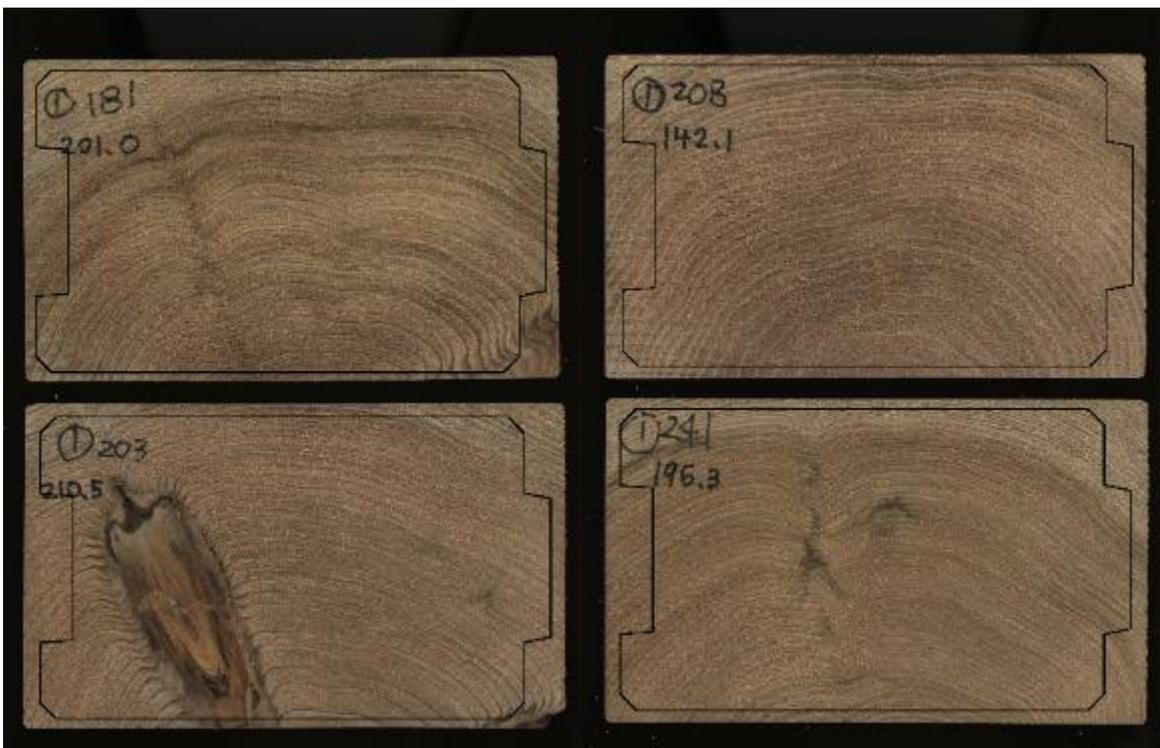
写真 3.2.5-46 乾燥スケジュール①の切片画像（ログ加工時その4）と重ね合わせた角ログ断面図
