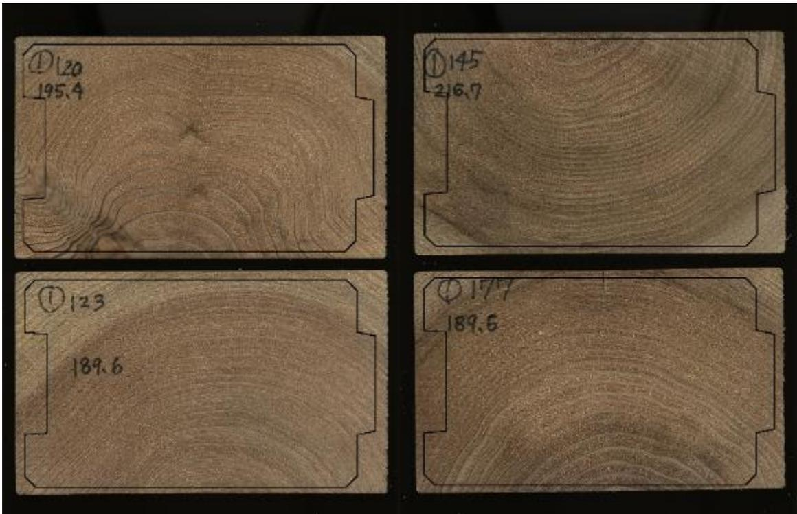
写真 3.2.5-45 乾燥スケジュール①の切片画像（ログ加工時その3）と重ね合わせた角ログ断面図
