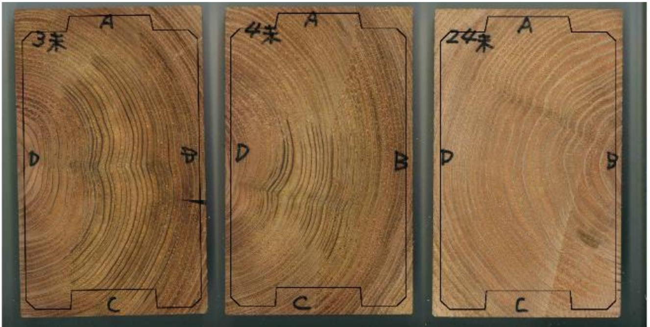
写真 3.1.5-1 GIMP を用いた角ログの断面図と切片画像の重ね合わせ
