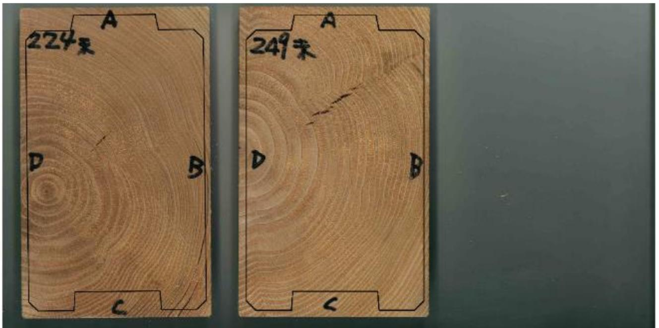
写真 3.2.5-42 乾燥スケジュール③の切片画像（その 14）と重ね合わせた角ログ断面図
