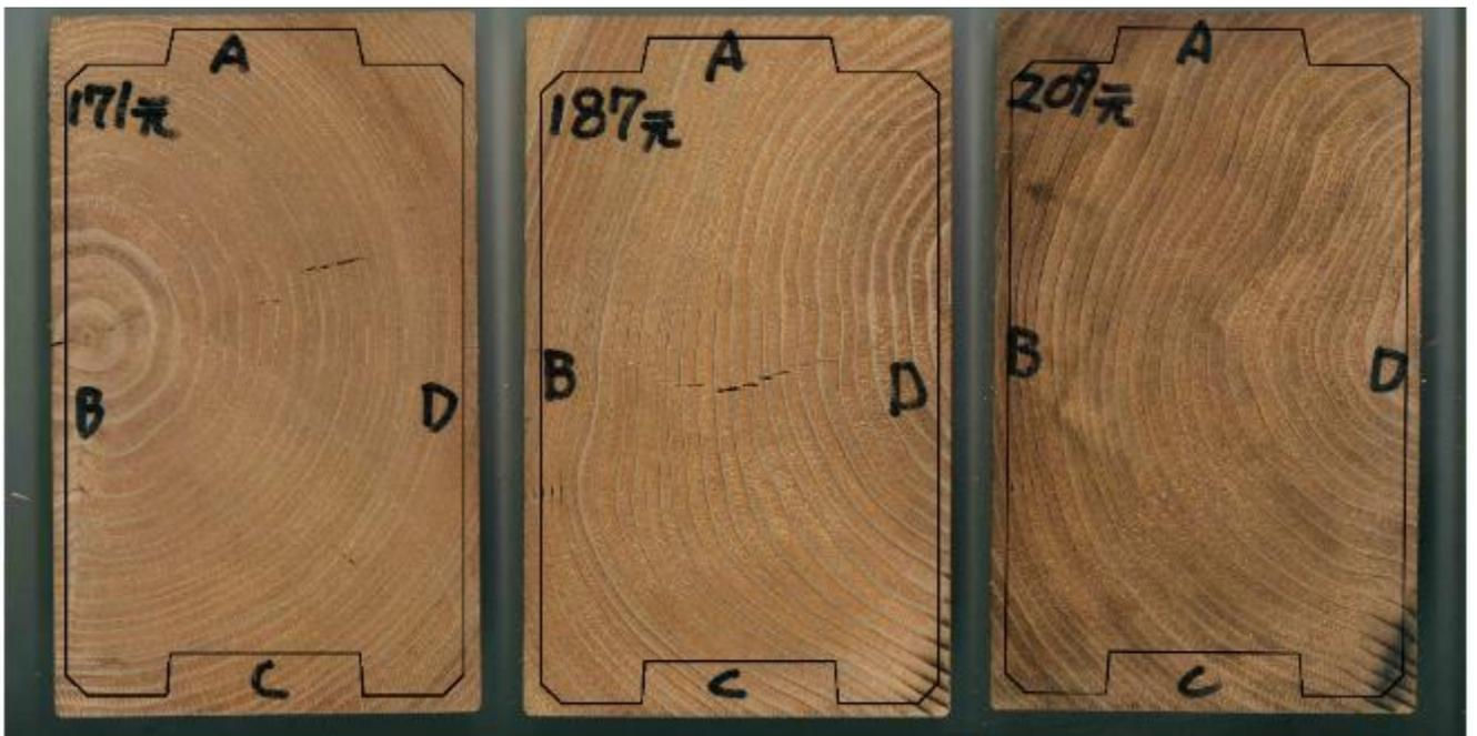
写真 3.2.5-34 乾燥スケジュール③の切片画像（その 6）と重ね合わせた角ログ断面図
