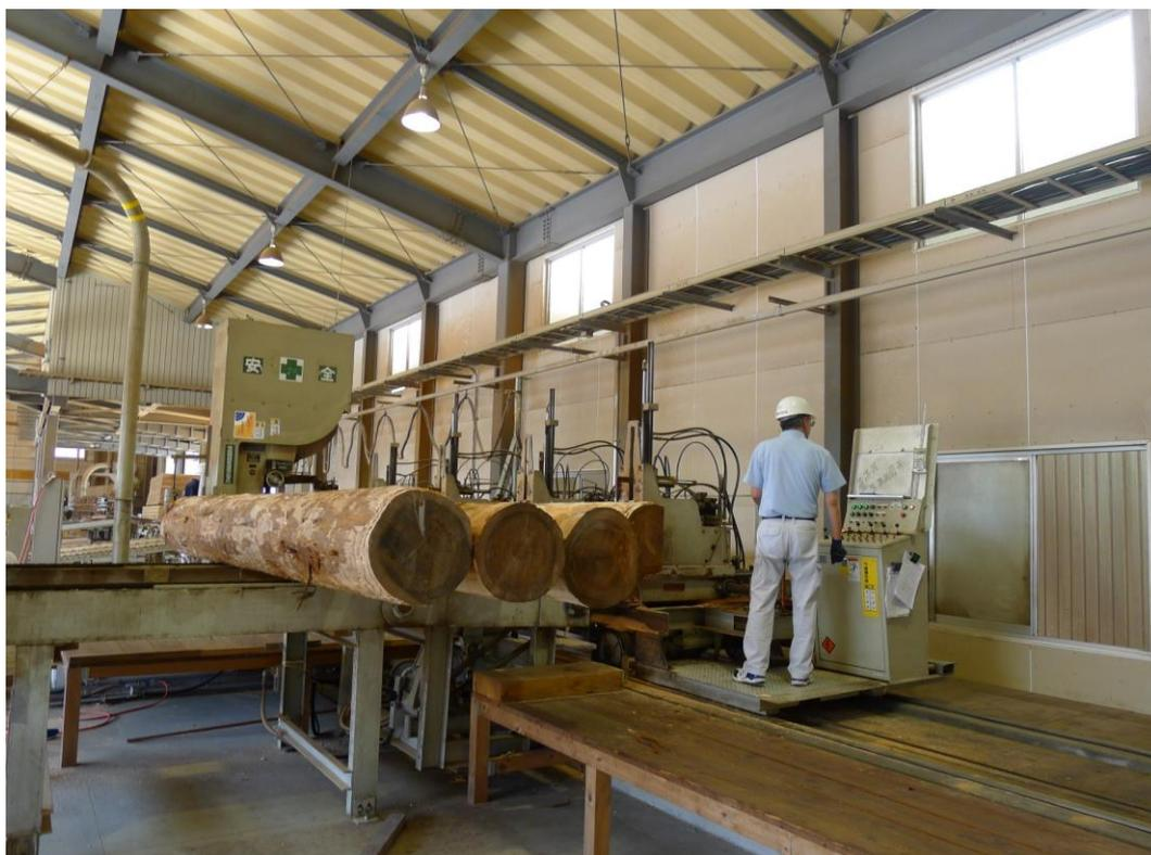
写真 2.1.1-2 軽便送材車付帯鋸盤（台車）
