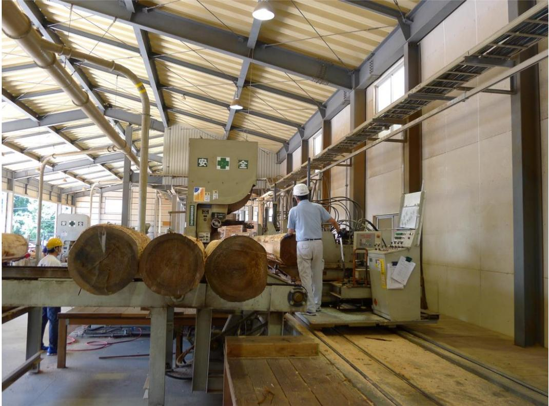
写真 1-1 軽便送材車付帯鋸盤による製材
