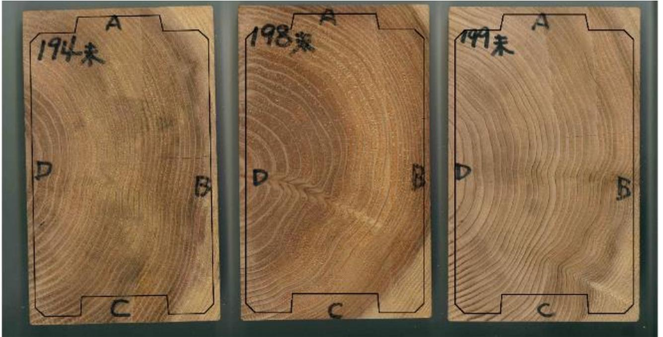
写真 3.2.5-27 乾燥スケジュール②の切片画像（その 13）と重ね合わせた角ログ断面図
