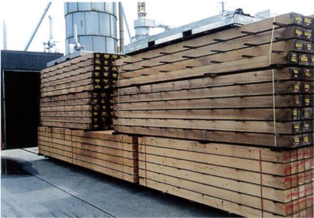
写真 1-5 乾燥試験（高温セット処理後の取り出し）
