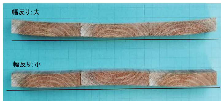
写真2 矧ぎ合わせ接着した板目板の収縮変形（木表・木裏の配置に注目）
