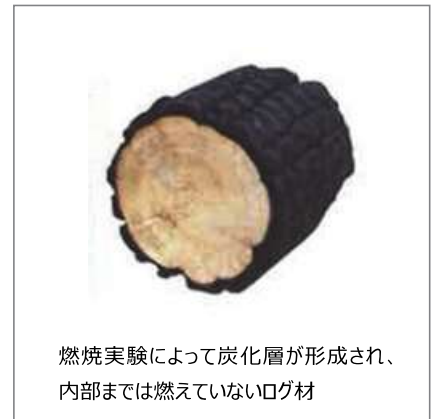
図 3.1 ログ材の炭化層の形成
