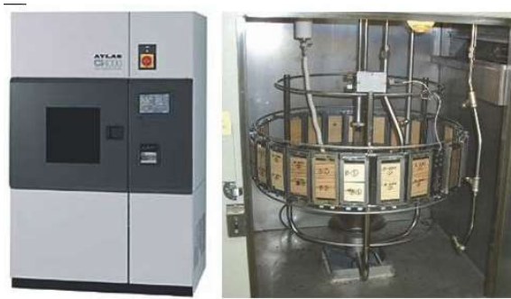
促進耐候性試験（キセノンランプ法の 2500 時間が屋外暴露南向き 45 度の 2 年分に相当）
