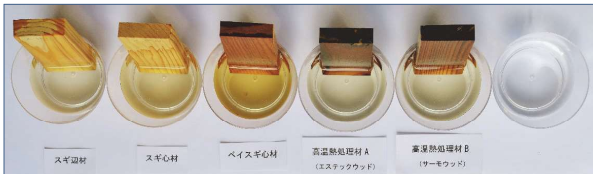
写真 3.4 水溶性着色物質の溶脱の様子（左から 3 番目がベイスギ）
