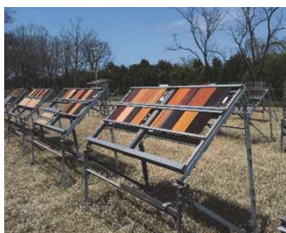
屋外暴露試験（南向き 45 度傾斜は南向き垂直の約 2 倍の速度で浸食される）
