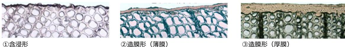
図 3.11 塗膜の断面
