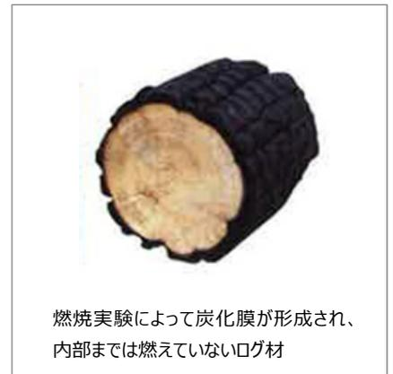
図 3.1 ログ材の炭化膜の形成
