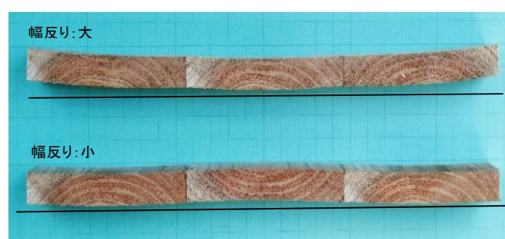
写真2 矶ぎ合わせ接着した板目板の収縮変形（木表・木裏の配置に注目）
